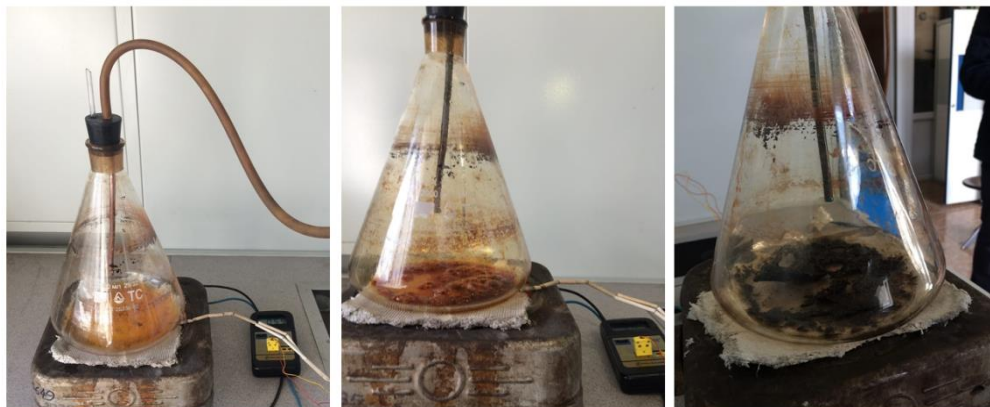
14 Сурет - Сұйық фазалық жану әдісімен \text{Fe}_3\text{O}_4 магнетит нанобөлшектерін синтездеу процесінің әр сатысындағы фотосуреттер
