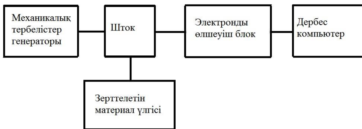
11 Сурет - Вибрациялық магнитометр жүйесінің жиналу схемасы
